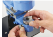
安全ロック機構でダイの横みを解消します。
