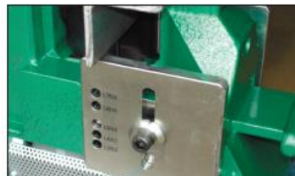
スーパーベンダー加工部 (KZ-75B) 誰でも簡単に位置合わせができるガイド 加工精度、作業性が向上
